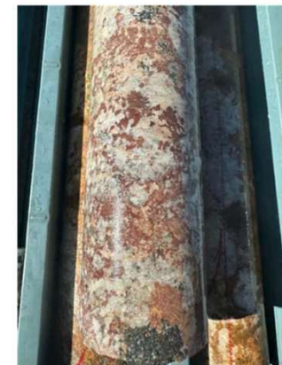
右图：在MWDD10101地表以下约 70 米处观察到红色稀土碳酸盐矿物颗粒**
